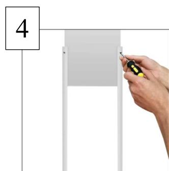
Fixez les deux rails de porte en aluminium des deux côtés de la porte du poulailler.
